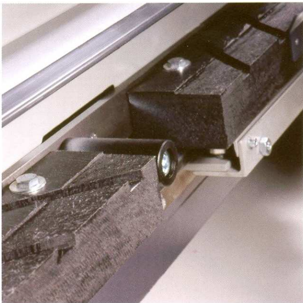
Plan d'appui inférieur sur des blocs en matériaux composites durs, glissants et résistants à l'usure. Galets escamotables pour le chargement et transport des panneaux en option.
