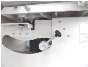
Réglage vertical et escamotage rapide de l'inciseur par levier et came
