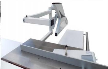
Bras support de cape articulé permettant l'usinage de pièces encombrantes en hauteur
